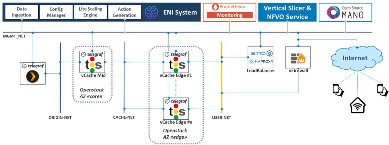
FIGURE 29: SERVICE COMPONENTS FOR THE DEMONSTRATION AT THE OSM ECOSYSTEM DAY
