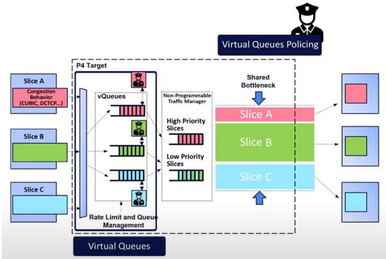
FIGURE 33: VIRTUAL QUEUE IMPLEMENTATION OVER P4 PIPELINE
